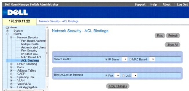
Рис. 7-14. Страница Network Security - ACL Binding (Безопасность сети - Привязки ACL)
